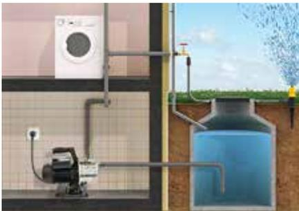
Diese Pumpen sind nicht geeignet für Meerwasser, Abwasser oder Wasser mit korrosiven oder leicht brennbaren Flüssigkeiten.
