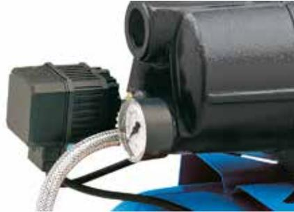
Die Start- und Stoppdrücke sind vom Hersteller voreingestellt (einstellbar für spezifische und unterschiedliche Anforderungen), aber die Pumpen sind dennoch mit einem Druckschalter zur Einstellung und Messung des Drucks (Standard oder elektronisch) ausgestattet.
