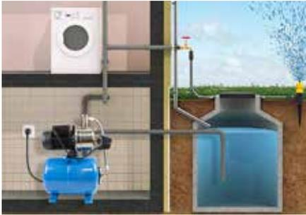
Diese Pumpen sind nicht für Meerwasser oder für Wasser mit korrosiven oder leicht brennbaren Stoffen geeignet. Beide Modelle haben eine korrosionsfreie Motorwelle aus Edelstahl AISI 416.
