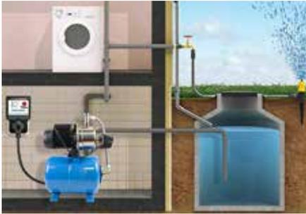
Logic Drop ist ein elektronisches Gerät für Trockenlauf und Motorüberlastschutz. Es ist sehr einfach zu installieren; es erfasst die technischen Daten der Pumpe bei der ersten Inbetriebnahme und hält sie auch bei einer vorübergehenden Stromabschaltung aufrecht.
