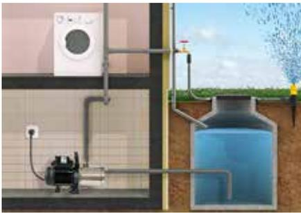
Die Serie Evo-Multimax besteht aus selbstansaugenden Pumpen mit mehrstufigem Hydrauliksystem.
