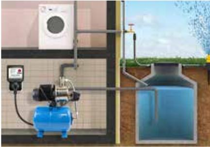
Diese Pumpen sind nicht für Meerwasser oder für Wasser mit korrosiven oder leicht entzündlichen Stoffen geeignet. Die Start- und Stopdrücke sind vom Hersteller voreingestellt (einstellbar für spezifische und unterschiedliche Anforderungen), aber die Pumpen sind dennoch mit einem Druckschalter zur Einstellung und Messung des Drucks (Standard oder elektronisch) ausgestattet.
