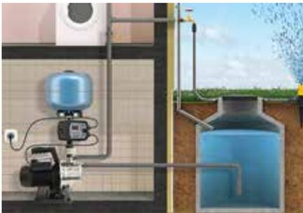
DIGIPRESS ist ein elektronischer Druckschalter mit integriertem digitalem Manometer. Es kann das Starten und Stoppen von einphasigen Elektropumpen bis 2,2 kW verwalten. Er kann als Differenzdruckschalter, als invertierter Druckschalter oder einfach nur mit Maximal- oder Minimaldruck arbeiten
