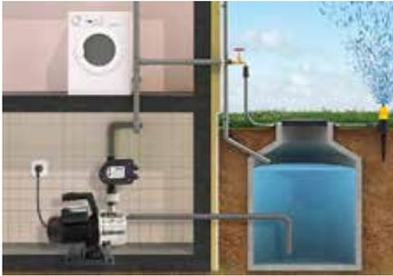
PRESSUREMATE 1.5 ist eine elektronische Vorrichtung, die die Pumpe in Abhängigkeit von der Bedienung und dem Schließen der Wasserhähne startet und stoppt. Wird kein Wasser zugeführt, stoppt die Elektronik die Pumpe, um sie vor Trockenlauf zu schützen.
