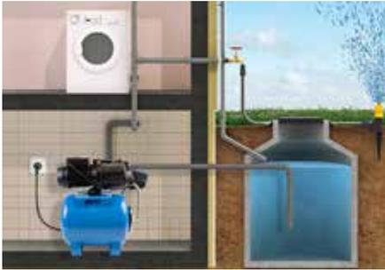
Diese Pumpen sind nicht für Meerwasser oder für Wasser mit korrosiven oder leicht brennbaren Stoffen geeignet. Sie sind alle mit einer Motorwelle aus Edelstahl AISI 416 (korrosionsbeständig) ausgestattet.
