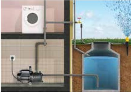
Diese Pumpen sind nicht geeignet für Meerwasser, Abwasser oder Wasser mit korrosiven oder leicht brennbaren Flüssigkeiten. Sie haben eine Motorwelle aus Edelstahl (Antikorrosion) und der Motor hat ein eingebautes Thermoschutzrelais, um den Motor vor Überhitzung zu schützen.
