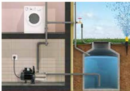
La gama Evo-Multimax está compuesta por bombas autocebantes con sistema hidráulico multietapa..
