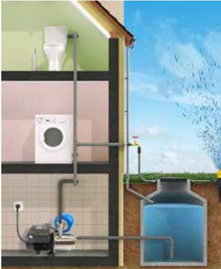
EVOTRONIC 350 es un sistema compuesto por una electrobomba multicelular autocebante con el cuerpo de la bomba en acero inoxidable y con un variador de velocidad electrónico que, en base a la demanda efectiva de agua, permite mantener la presión constante de la instalación, reduciendo o aumentando la velocidad de rotación del motor de la electrobomba.
