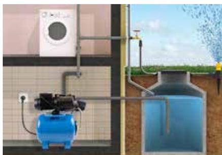
Estas bombas no son adecuadas para agua de mar o para agua que contenga sustancias corrosivas o fácilmente inflamables. Todos ellos están equipados con un eje motor de acero inoxidable AISI 416 (anticorrosión).
