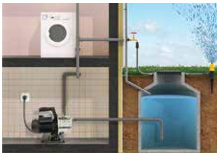
Estas bombas no son adecuadas para agua de mar, aguas residuales o aguas que contengan fluidos corrosivos o fácilmente inflamables. El sistema hidráulico de estas bombas está completamente en NORYL.
