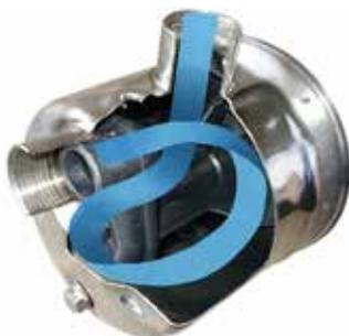
La bomba arranca automáticamente cada vez que se solicita agua y la presión del sistema cae por debajo del valor mínimo fijado en 1,5 bar. La bomba sigue funcionando mientras se solicita agua. Después de eso, la bomba sigue funcionando durante unos segundos para restablecer la presión hidráulica en el sistema.
