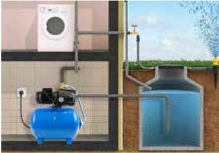
Estas bombas no son adecuadas para agua de mar o para agua que contenga sustancias corrosivas o fácilmente inflamables. Ambos modelos tienen un eje motor de acero inoxidable AISI 416 anticorrosivo.
