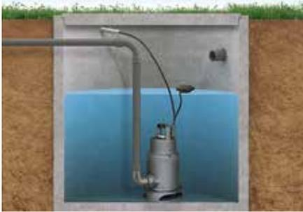
Las bombas FP y VIPVORT son adecuadas para el bombeo de aguas residuales con impurezas de hasta 25 mm de tamaño (según el modelo). Están equipados con un eje motor de acero inoxidable
