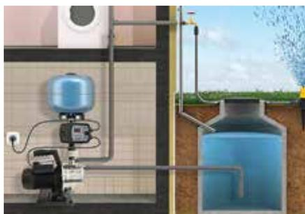
El dispositivo DIGIPRESS es un presostato electrónico con manómetro digital incorporado. Permite automatizar una bomba monofásica hasta 2,2 kW. Los valores de presión se pueden regular de manera sencilla desde el panel de control digital. De hecho, permite la lectura instantánea.
