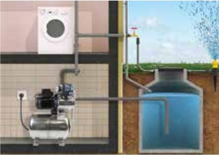
These pumps are not suitable for sea water or for water containing corrosive or easily inflammable substances. Los niveles de presión de arranque y parada están preajustados por el fabricante (ajustables para requisitos específicos y diferentes), pero las bombas están equipadas con un interruptor de presión para el ajuste y la medición de la presión (estándar o electrónico).
