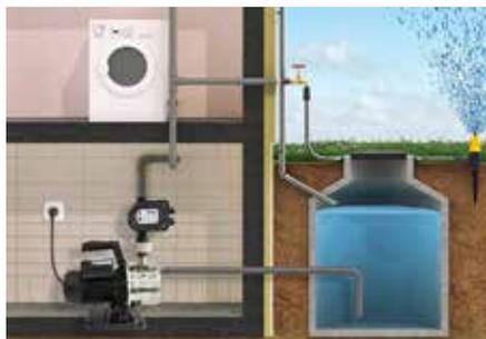
Los modelos AUTOJET están equipados con un panel LED para controlar el estado de funcionamiento de la bomba: por lo tanto, es posible verificar si la bomba está alimentada, si está en funcionamiento, si hay un flujo de agua, si hay condiciones inusuales y, en caso afirmativo, cuáles son (por ejemplo, falta de agua).
