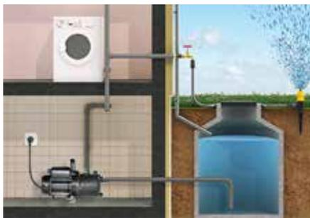
Estas bombas no son adecuadas para agua de mar, aguas residuales o agua que contenga fluidos corrosivos o fácilmente inflamables. Tienen un eje del motor de acero inoxidable (anticorrosión) y el motor lleva incorporado un relé de protección térmica para proteger el motor del sobrecalentamiento.
