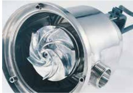
El motor se enfría a través de una cámara de intercambio de calor que permite que la bomba funcione durante largos períodos sin estar completamente sumergida.
